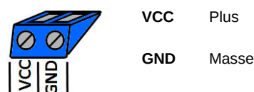
Fig. 2: Exemple alimentation en tension (bleu)
